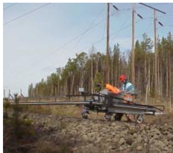
Att vara spårhund efter kablar är en av laserscannerns funktioner, men den kan också avläsa bankettens profil. Väger 200 kg och har en räckvidd på 9 m.
